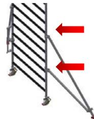
4. Ausleger gemäß Abbildung ausrichten. Als Hilfe zum Ausrichten können folgende Abstände verwendet werden:
