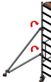
6. Dreiecksausleger nach unten drücken, sodass der Fuß einen festen Kontakt mit dem Boden hat. Gleichzeitig den Rohrverbinder am Gelenk festschrauben.
