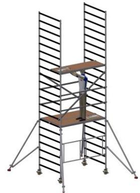
7. Sitzend vom Durchstiegsbelag aus die Horizontalen und Diagonalen an der Außenseite montieren.
