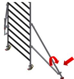
Die Montage der Ballaste **bei freistehendem, mittigem Aufbau** ist wie folgt vorzunehmen:
