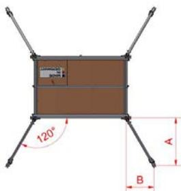
5. Nach dem Ausrichten sind die Rohrschellen mit den Flügelmuttern festzuziehen.
