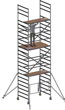
12. Sitzend vom Durchstiegsbelag aus die Horizontalen und Diagonalen an der Außenseite montieren.
