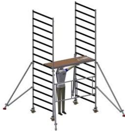
2. Sitzend vom Durchstiegsbelag aus die Horizontalen und Diagonalen an der Außenseite montieren.
