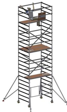
15. Horizontale der unteren Ebene (*Handlauf und Knieholm*) in die Mitte verschieben. Durchstiegsbelag der obersten Ebene zurückschieben. Belag aus zweiter Ebene aus- und in dritte Ebene einhängen. Bordbretter montieren.
