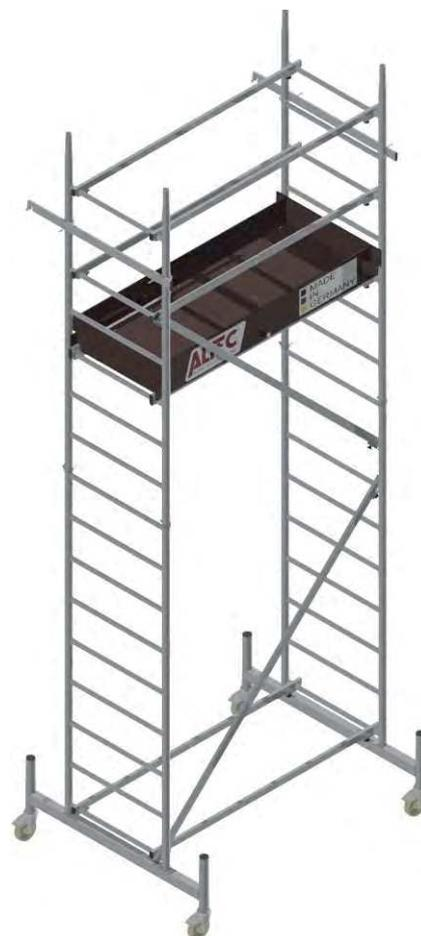
Stecken Sie im Verband die Bordbretter wie dargestellt auf den Durchstiegsbelag. Schrauben Sie die Bordbretter mit den Sechskantschrauben M8x40mm, Unterlegscheiben für M8 und den Flügelmuttern M8 seitlich an den Durchstiegsbelag fest.
