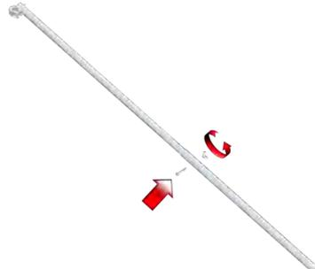
3. Ausleger mit den Rohrschellen unterhalb der obersten Sprosse des Basisrahmens und oberhalb der 1. Sprosse anbringen, jedoch für das Ausrichten noch nicht festziehen.
