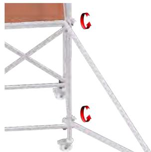
6. Dreiecksausleger nach unten drücken, sodass der Fuß einen festen Kontakt mit dem Boden hat. Gleichzeitig den Rohrverbinder am Gelenk fest verschrauben.
