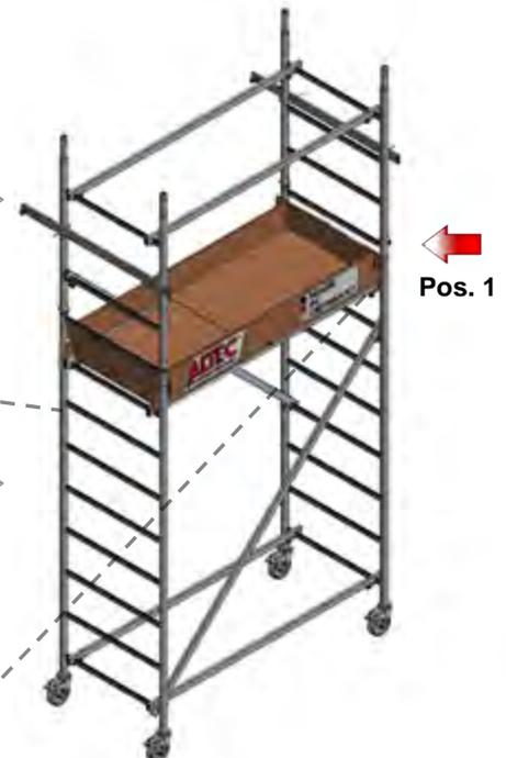
Stecken Sie im Verband die Bordbretter wie dargestellt auf den Durchstiegsbelag. Schrauben Sie die Bordbretter mit den Sechskant-Schrauben M8x40mm, Unterlegscheiben für M8 und den Flügelmuttern M8 seitlich an den Durchstiegsbelag fest.
