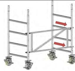
3. Fixieren der Bremsen an den Lenkrollen, bevor man mit dem Aufbau fortsetzt.
