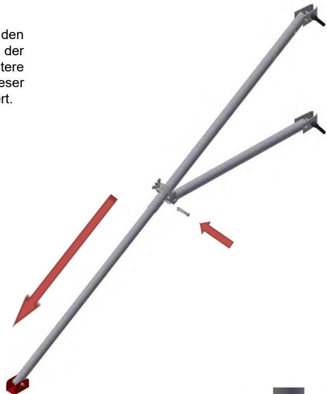
Bei der Montage werden die Dreieck-Ausleger an den Holmen der Vertikalrahmen befestigt. Die Befestigung erfolgt mit Hilfe der Rohrschellen. Diese werden mit Knebelmutter an den Holmen verschraubt.
