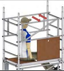
24. Plattform betreten und Durchstiegsbelag schließen. Den Bordbrettsatz auf den Durchstiegsbelag aufsetzen.
